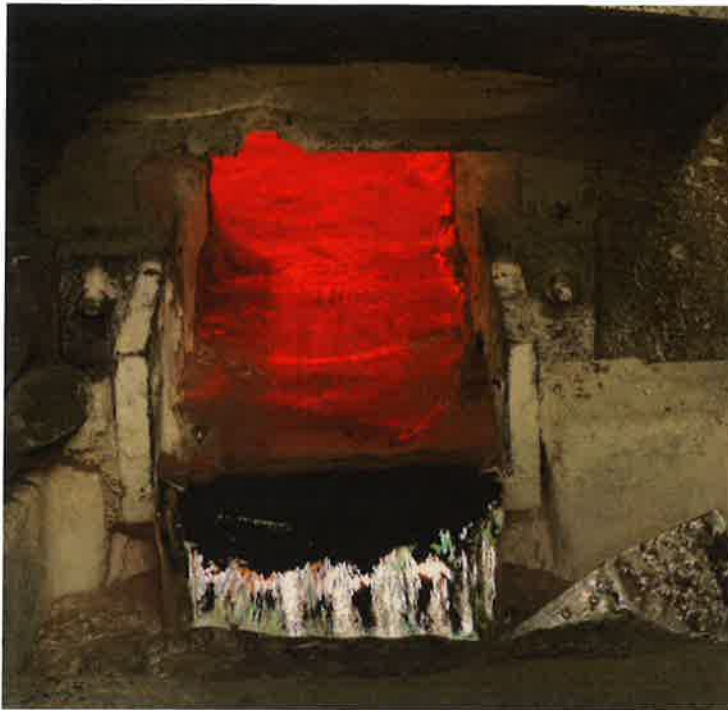
Slika 5 Lijevanje aluminija kroz žljebove
