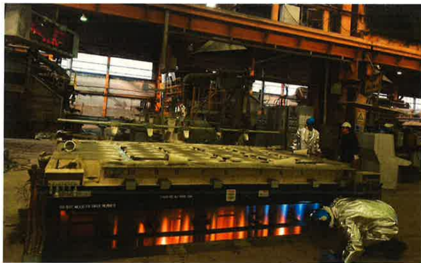
Slika 4 Vađenje ohlađenih trupaca iz kalupa nakon lijevanja
