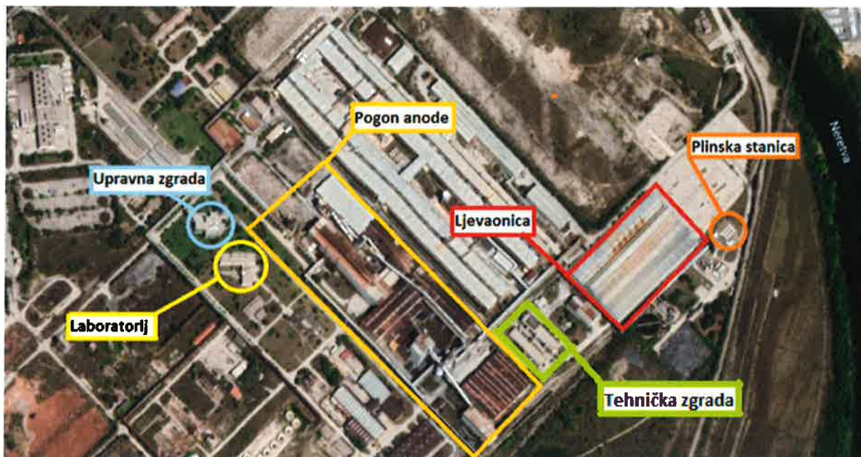
Slika 4 Raspored glavnih objekata u tvornici aluminija
